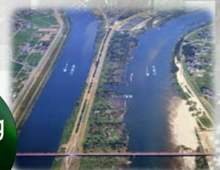
Môi trường sông điều chỉnh dòng chảy dạng Krib ở sông Kisougawa
