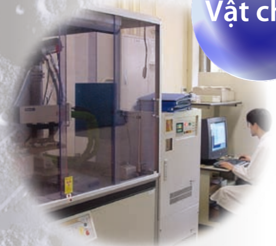
Thiết bị phân tích cấu tạo kết tinh sử dụng tia X siêu mạnh độ nhạy cao
